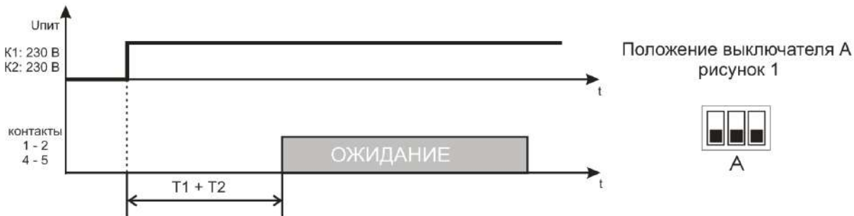
Рисунок 3 – Алгоритм работы Реле с задержкой на включение
