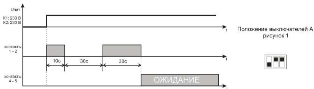
Рисунок 6 – Алгоритм работы Реле управления (предпусковая сигнализация)
