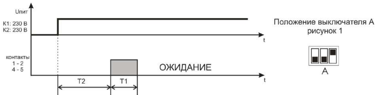
Рисунок 4 – Алгоритм работы Реле импульсное 1
